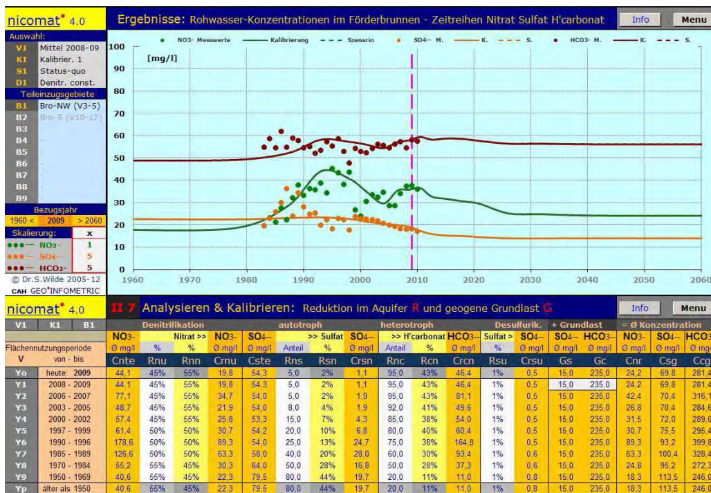
Abb. 5-5 Beispiel einer Darstellung im Nicomat-Programm (hier: WGG Brochterbeck, TEZG Nordwest), oben: Ergebnisdigramm mit Messwerten (Punkte) und berechnetem Konzentrationsverlauf (Ganglinien Nitrat, Sulfat, Hydrogencarbonat) in Vergangenheit (Kalibrierung) und Zukunft (Prognose „Status quo“), unten: Eingabeseite (Eingabefelder weiß) mit Parametern des Stoffumsatzes (Abbauleistung und stöchiometrische Anteile autolitho-/heterotrophe Denitrifikation).
