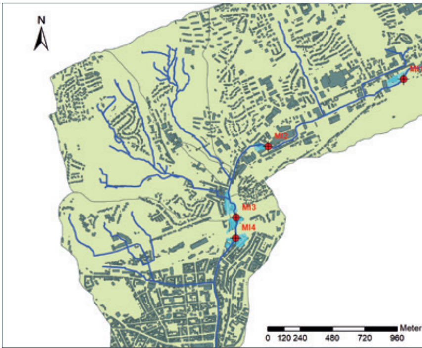
Abb. 2: Exemplarischer GIS-Datenauszug für einzelne Hotspots, Überflutungsflächen eines 500-jährlichen Hochwassers und betroffener Gebäude
