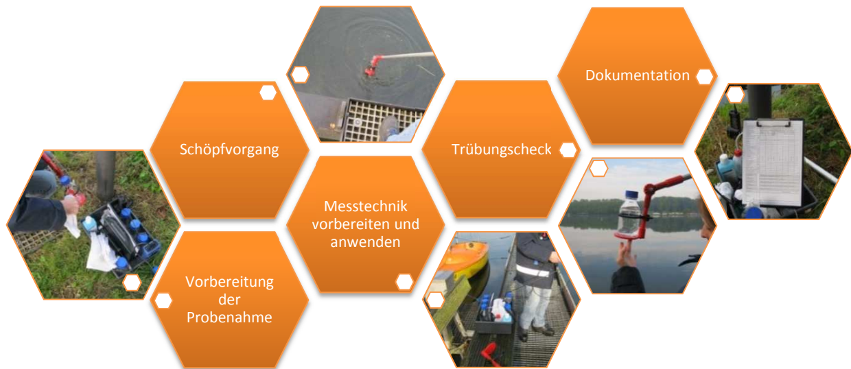
Abbildung 21: Ablauf einer Probeentnahme zur Überwachung von Badegewässer 119
