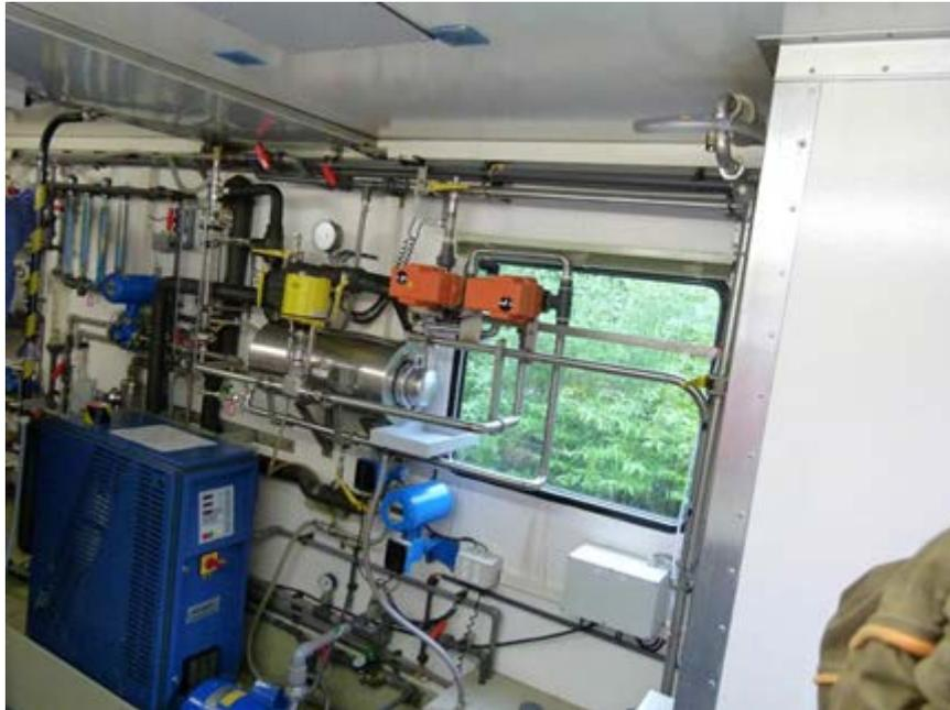
Abbildung 3: Teil der Container-Versuchsanlage zur Kühlwasserkonditionierung
