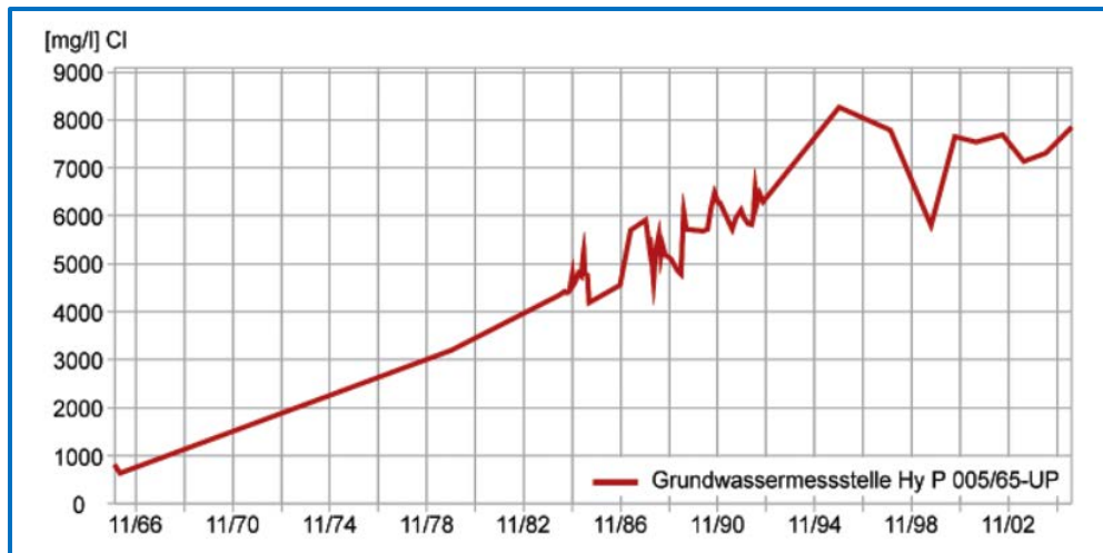
Abbildung 16: Anstieg der Süß-Salzwassergrenze indiziert anhand der Entwicklung der Chloridkonzentration an einer Grundwassermessstelle in der Havelrinne (Quelle: Nillert et al., 2008)
