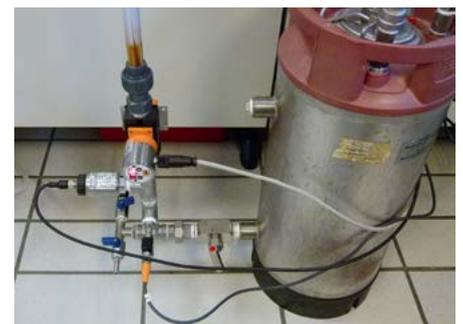
*Druckgefäß für das Testwasser und Sensorik am Fuß eines Testmoduls (im Vergleich zum Großmodul in gleicher Länge jedoch mit stark reduzierter Anzahl der Membranfasern).*
