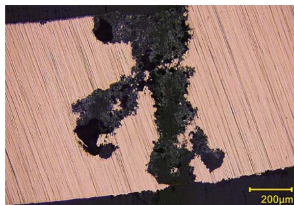
Seit etwa 2003 bis 2005 werden vermehrt Schäden an Trinkwasser-Installationen festgestellt, in denen halbharte Kupferstangenrohre (R 250) verarbeitet wurden, teilweise auch in Versorgungsgebieten, die bisher als nicht schadensauffällig galten. Schäden wurden bisher nur an Rohren, nicht an Fittings festgestellt.
