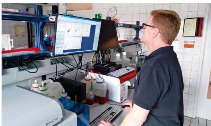
Zählung von Bakterien in einer Wasserprobe mit dem Durchflusszytometer
