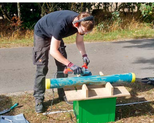
Abb. 1: Bohrkernuntersuchungen zur Ermittlung des Denitrifikationspotentials
