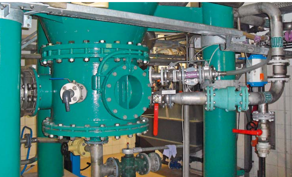
Abb. 1: Mischtopf eines Schnellentcarbonisierungsreaktors
