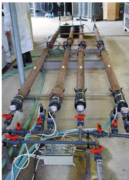
Abb. 1: Simulation des Korrosionsverhaltens von Stahlrohren im halbtechnischen Maßstab
