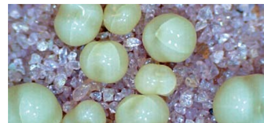
Abb. 3: Granat-Impfsand und Pellets aus einem Schnellentcarbonisierungsreaktor
