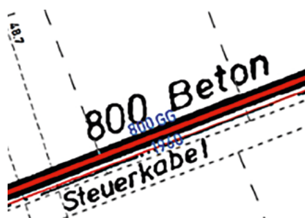
Abb. 1: Bereinigung eines typischen Ersterfassungsfehlers, bei dem Sachdaten im GIS-System (hier: Material Grauguss „GG“) nicht mit dem Planwerk aus der Zeit der Verlegung übereinstimmen (hier: (Spann)beton)
