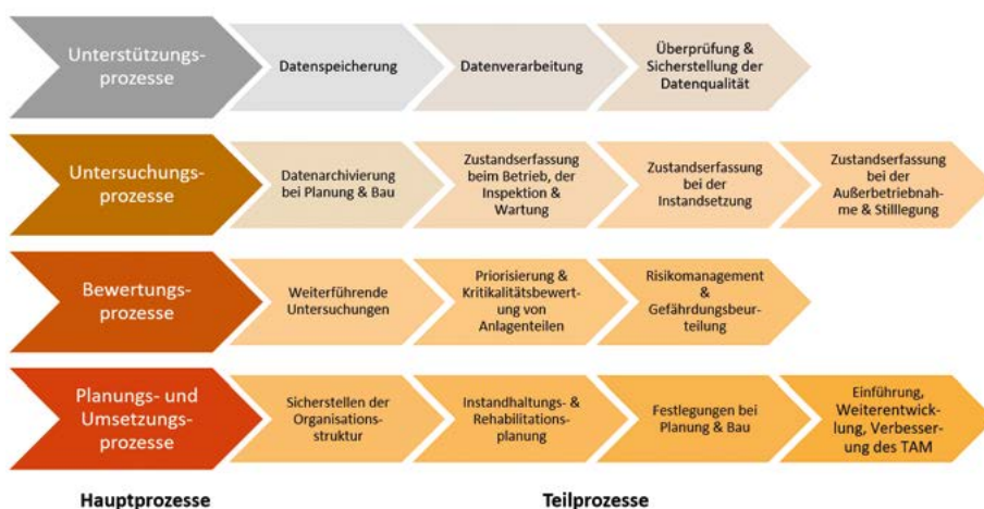
Abb. 1: Prozesse im Technischen Anlagenmanagement
