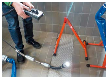
Abb. 2: Beispiele zu Methoden der Zustandsbewertung: Intelligenter Molch (links: Xylem PipeDiver®), Kamera-befahrung (oben), Geräuschpegellogger (rechts unten) oder klassische Materialprüfung (rechts oben)
