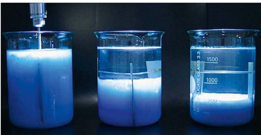
Flockung mit anschließender Sedimentation (Quelle: IWW)
