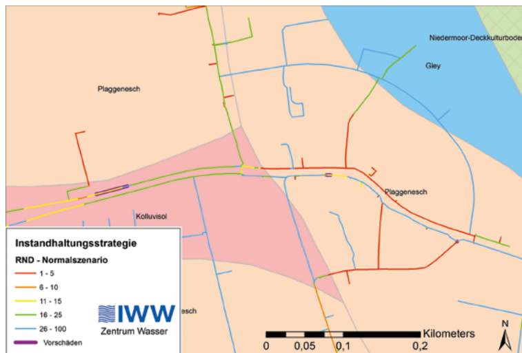
Abb. 3: Abgleich der Lage von Schadensdaten mit der prognostizierten Restnutzungsdauer (RND) der bewerteten Teilabschnitte (Detailbetrachtung) und den verfügbaren amtlichen Bodenarten. Bei einer korrekten Bewertung müssen zustandsbedingte Schäden deutlich häufiger auf Leitungsabschnitten mit schlechterem prognostizierten Zustand liegen. Ungenauigkeiten zwischen Bewertung und Lage der Schäden sind im urbanen Raum niemals vollständig zu vermeiden. Mögliche Ursachen sind einzel-fallabhängig zu diskutieren (Quelle: IWW; Geologischer Dienst / NRW 2019)
