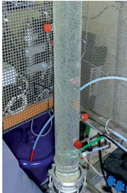
Abb. 4.2: Pilotanlage zur Ozonung aus dem Verbundprojekt SAUBER+
