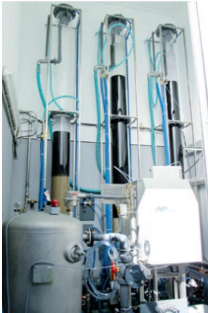
Abb. 4.1: Untersuchungen zur Adsorption an granulierte Aktivkohle im Verbundprojekt SchussenAktivplus
