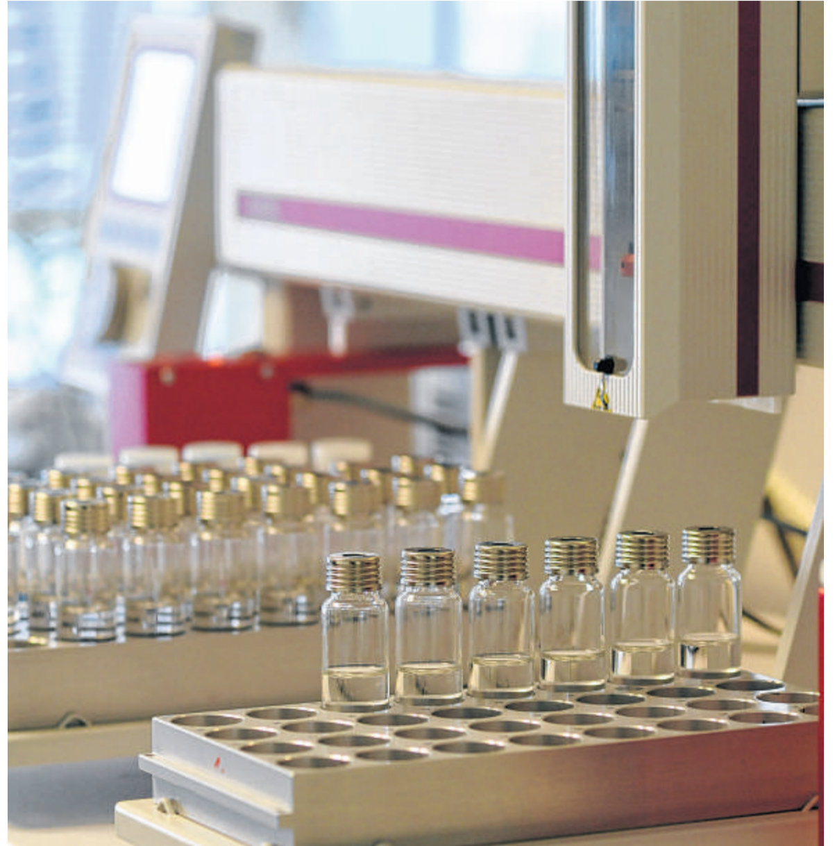
Die in kleine Glasbehälter gefüllten Extrakte werden mit Hilfe des Gaschromatographen vollautomatisch identifiziert und zu einem Datensatz verarbeitet, den die Chemisch-technische Assistentin am PC-Bildschirm auswerten kann. FOTO: FABIAN STRAUH
