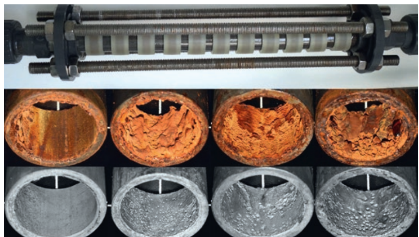
Abb. 1 – Ringsäule mit Stahl-Ringproben und Entwicklung der Eisendeckschichten und Werkstoffoberflächen
